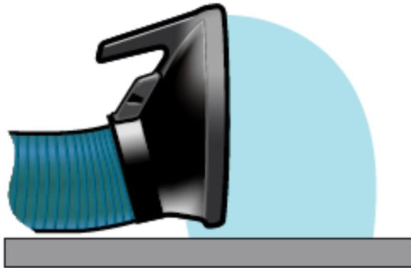
*Se o bocal é posicionado sobre uma superfície a eficiência de extração aumenta (efeito flange).*
