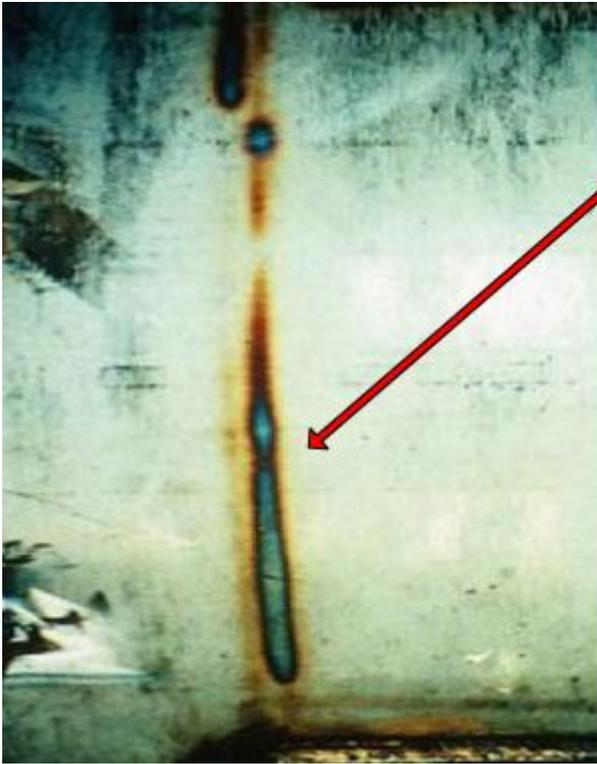
A Zona afetada pelo calor da solda também pode se formar na parte oposta da superfície soldada.
