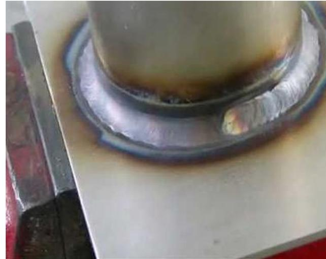
Devido ao aquecimento da solda, a camada passiva é removida da superfície da peça de aço inoxidável. Diminuindo a resistência a corrosão.
