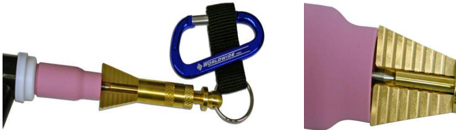
REGULADOR DE ALTURA DO TUNGSTÊNIO, BOCAL, PINÇA, DIFUSOR E CAPA LONGA E CURTA.
