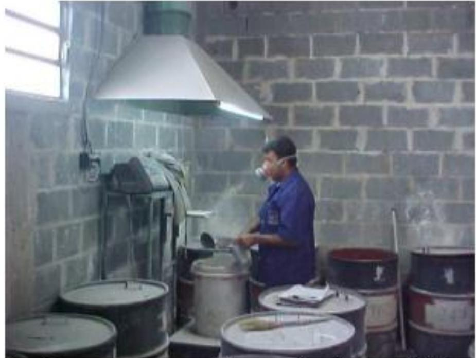
**2.** Pesagem e peneiramento das matérias-primas do revestimento.
