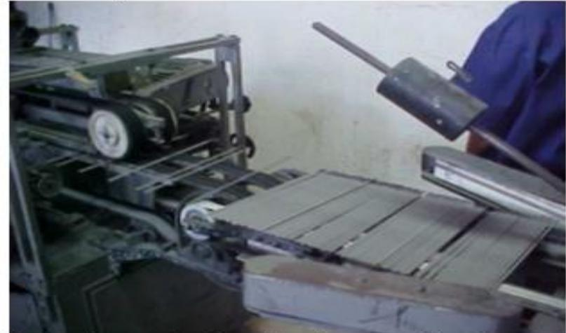
6. Acabamento do eletrodo revestido, fazer as pontas e identificação.
