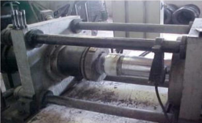
5. Prensa: a alma (vareta) e o bloco do revestimento são prensados juntos.
